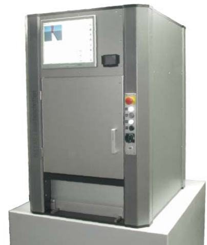
Bild 3: LCIA-gerechte Laserschweißmaschine mit 300-W-Diodenlaser: Das Werkstück wird über eine Schublade manuell zugeführt
