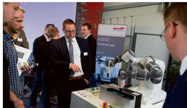
Kollaborierende Roboterarme montieren Teile zusammen. Privatbild
