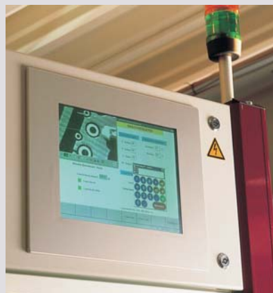
Komfortable Bedienoberfläche mit Touch-PC zur Prozess-visualisierung
