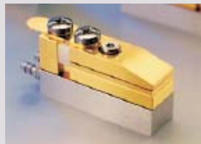
Montierter Laserdiodenbarren mit Wasserkühlung
