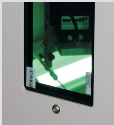
Schutzverkleidung (Laserklasse 1) mit Schaufenster
