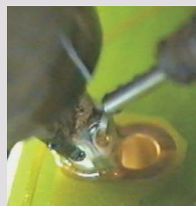
Vorwärmen der Lötstelle durch vorverzinnten LötKolben
